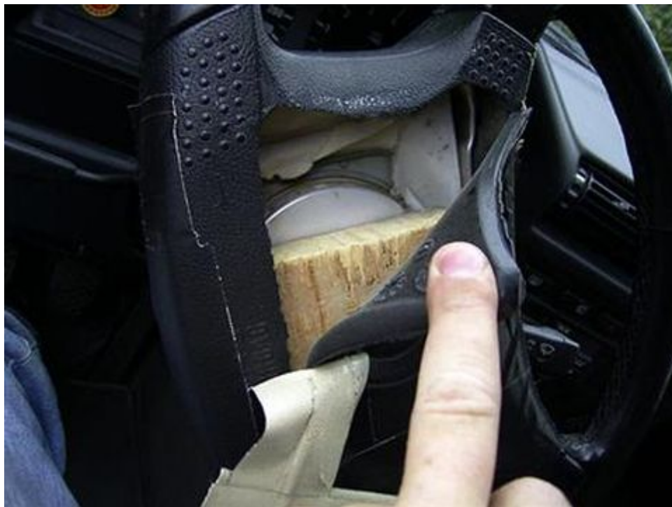
14. Légzsák helyett a „betoldott” fadarab is megteszi. Puhafa.
